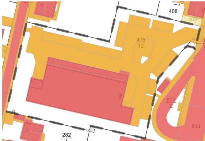
Abbildung 10: Versiegelte Flächen im Plangebiet, rot = voll versiegelte Dachflächen, orange = stark versiegelte und ggf. schmutzige Flächen (MWB)
