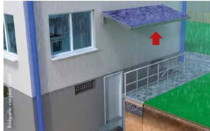
Eine Überdachung von Treppenabgängen verhindert, dass noch mehr Wasser eindringt
