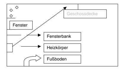
Eine typisch lüftungstechnisch bedingte Wärmebrücke: Die vom Heizkörper aufsteigende Warmluft strömt wegen einer zu breiten Fensterbank an der oberen Zimmerdecke vorbei. In der kühleren Ecke bildet sich Kondenswasser.
