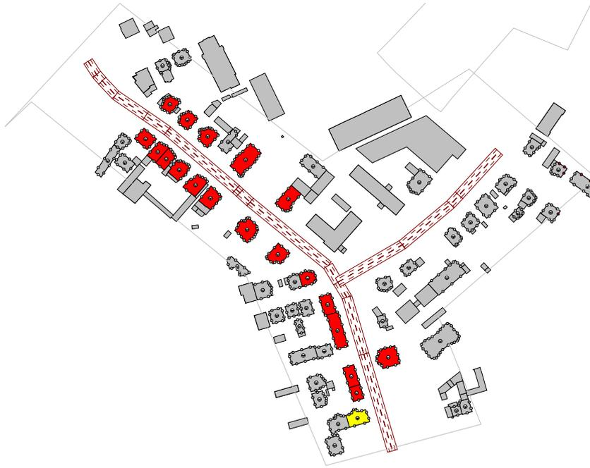
Abb. 50 rote Häuser = Überschreitung von  $L_{\text{DEN}} > 70 \text{ dB(A)}$  und  $L_{\text{Night}} > 60 \text{ dB(A)}$  Nachtwertes, gelbe Häuser = nur Überschreitung von  $L_{\text{DEN}} > 70 \text{ dB(A)}$
