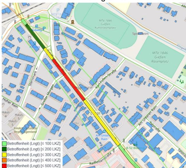
Abbildung 27: Visualisierung des Lärmkonfliktpunkts Schiffenberger Weg im Nachtzeitraum durch farbige Bänder der normierten Lärmkennziffer.<sup>58</sup>
