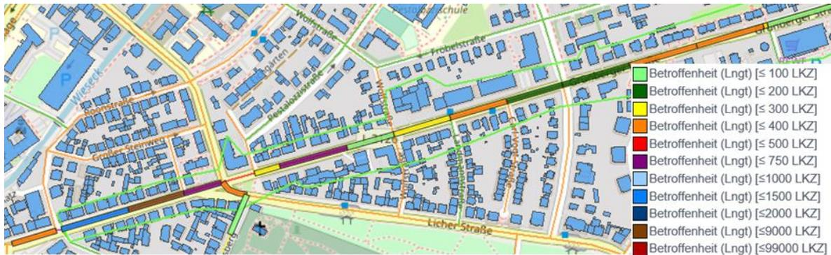
Abbildung 20: Visualisierung des Lärmkonfliktpunkts Grünberger Straße im Nachtzeitraum mit normierten Lärmkennzifferabschnitten. <sup>50</sup>
